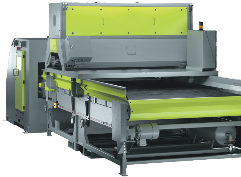
Mittels integrierter Sensoren ordnen Sortiermaschinen das vorhandene Material in sortenreine Kunststoffströme
