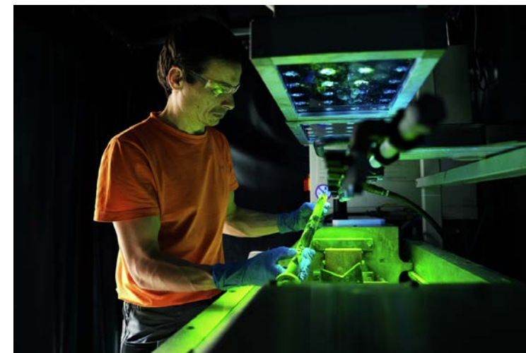
eXchange-Programm: Die Metallkomponenten der Lenksysteme durchlaufen hochpräzise diagnostische Überprüfungen, einschließlich der Rissprüfung mittels UV-Licht. Dieser Vorgang verhindert strukturelle Abweichungen Quelle: Robert Bosch GmbH
